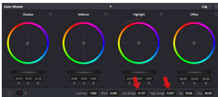
Abbildung 5-8: Festlegung der Weiß- und Schwarzwerte durch Low Range und High Range mit den Log Farbrädern
