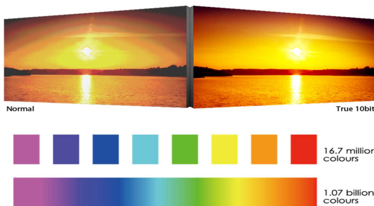
Abbildung 3-4: Vergleich von Farbverläufen zwischen 8-Bit und 10-Bit [18]
