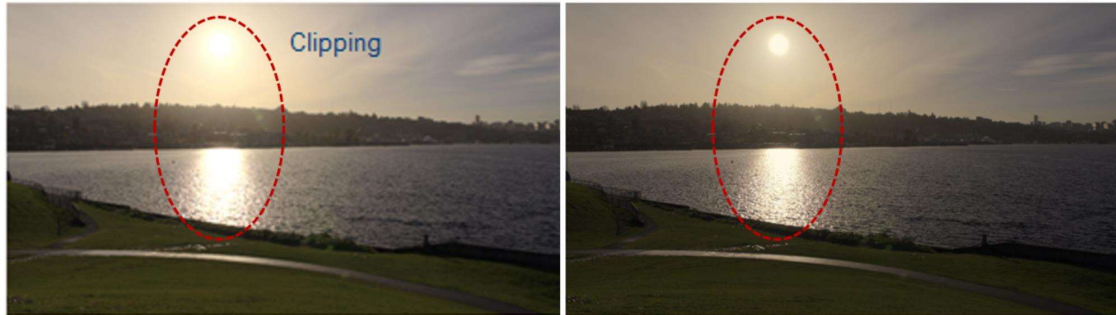
Abbildung 3-24: Gerade in den Highlights kann durch Tone Mapping Clipping entstehen [29]
