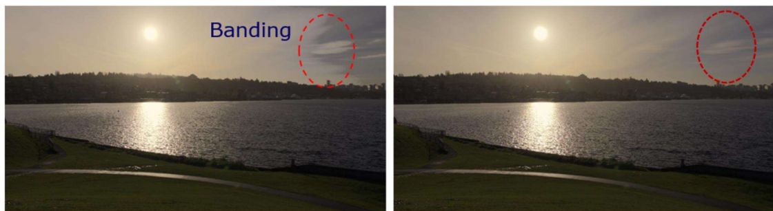
Abbildung 3-23: Banding kann durch eine falsche Tonemapping Kurve entstehen [29]
